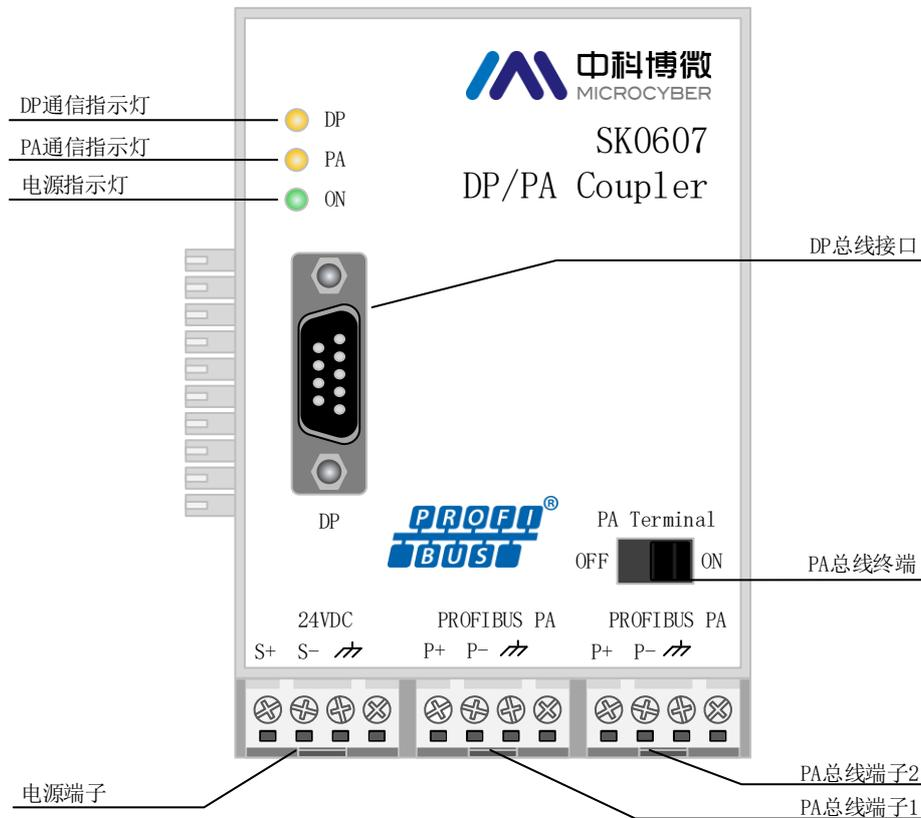
图 2.2 DP/PA 耦合器接口示意图
