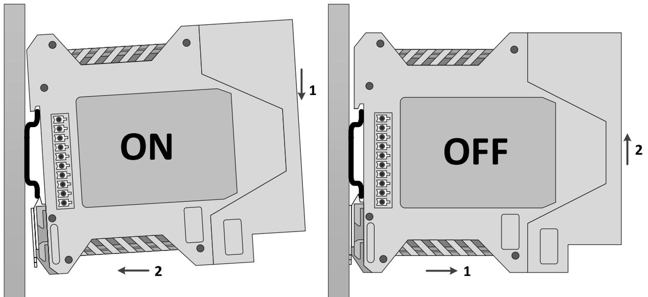
图 2.1 总线电源模块与总线终端 DIN 导轨安装示意图
